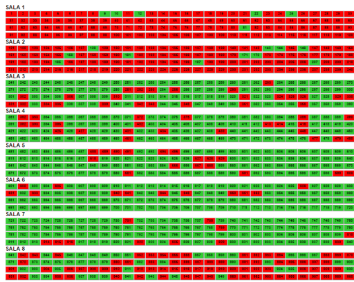
Figura 18 (a) Gráficos de mapeamento grupo versus localização física do forno conseguida pelo algoritmo Kohonen (SOM) para 2 Clusters . Experimento #1: Média com filtro.
