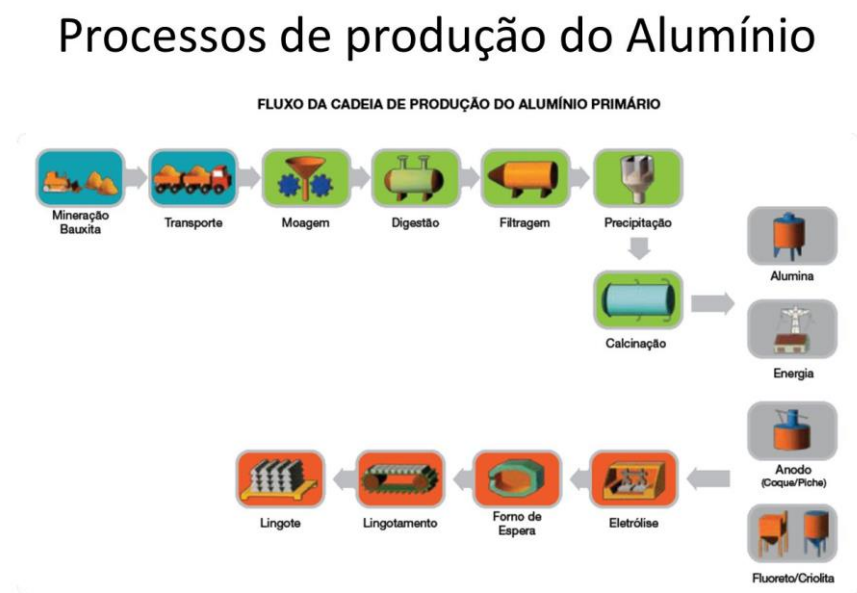
Figura 1 – Resumo do Processo de Produção da alumina e do alumínio primário.
